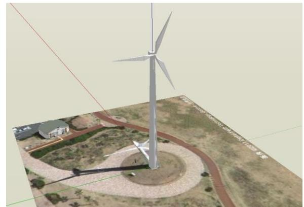
図-2 作成した風車と建物のモデル。設定日時を変更することにより、その日時に応じた日影像を描画する。
