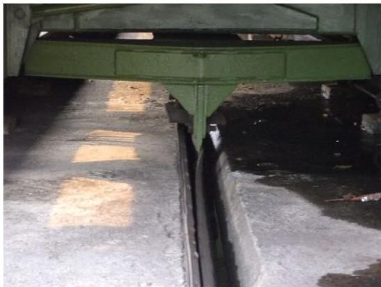
図8 スリットを通る接続板
