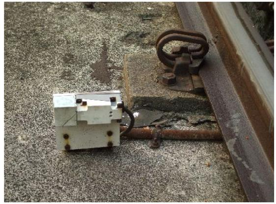
図10 ブルネルの時代にはなかった車両位置検知センサ
